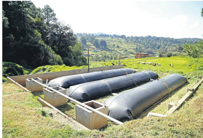
*Un bio-digesteur est une sorte de grand sac noir, fait d'une matière dense et étanche. Installé dans un long fossé creusé dans le sol, il reçoit chaque jour les déchets organiques de la ferme, puis transforme le fumier en biogaz (Ph. Sistema Biobolsa)*
